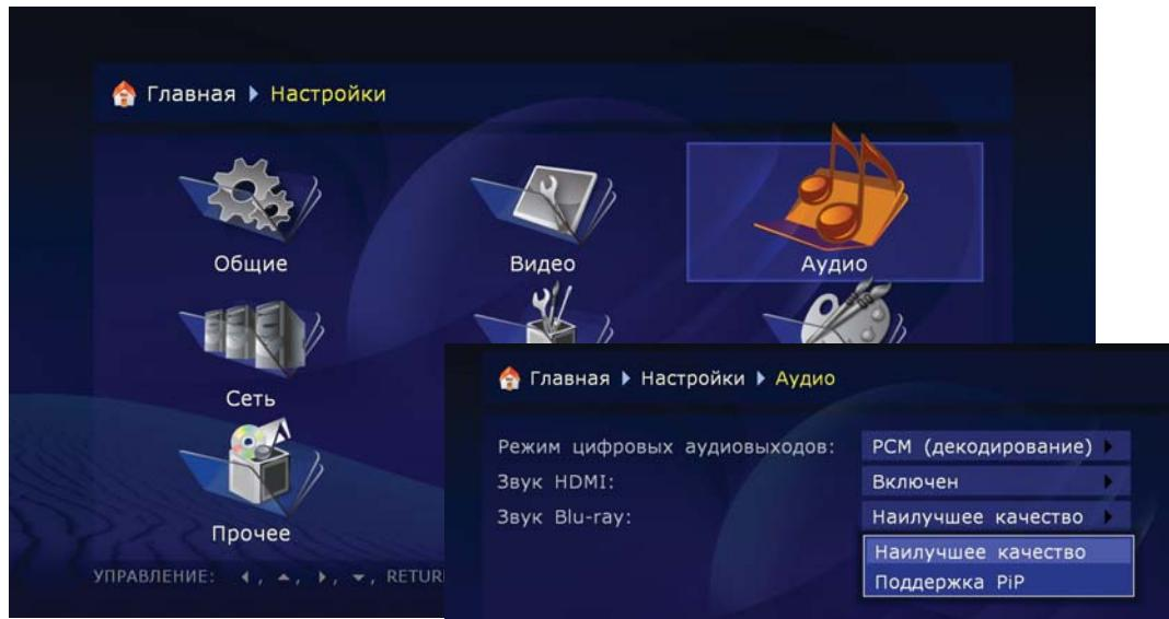
**Режим цифровых аудиовыходов:** позволяет менять режим работы цифрового выхода.
