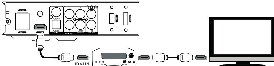
Данный медиаплеер оснащен современным интерфейсом HDMI версии 1.3, который позволяет передавать цифровые видео- и аудиопотоки через один единственный кабель. Если Ваш AV-ресивер оснащен входом HDMI версии 1.3 и декодером современных многоканальных форматов звука, таких как Dolby TrueHD и DTS-HD, то Вы сможете наслаждаться пространственным звучанием высокого разрешения в полной мере. Для такого рода подключения необходимо использовать кабель HDMI-HDMI, сертифицированный для версии протокола v1.3.
