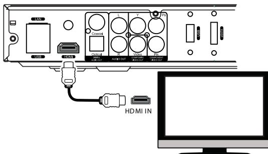
1. Если Ваш телевизор или проектор оснащен разъемом DVI, то используйте фирменный переходник Dune HDMI-DVI или соответствующий кабель. При этом передача звуковой дорожки с проигрывателя на ресивер (или телевизор) будет возможна лишь при подключении отдельного аналогового или цифрового аудио-кабеля.
