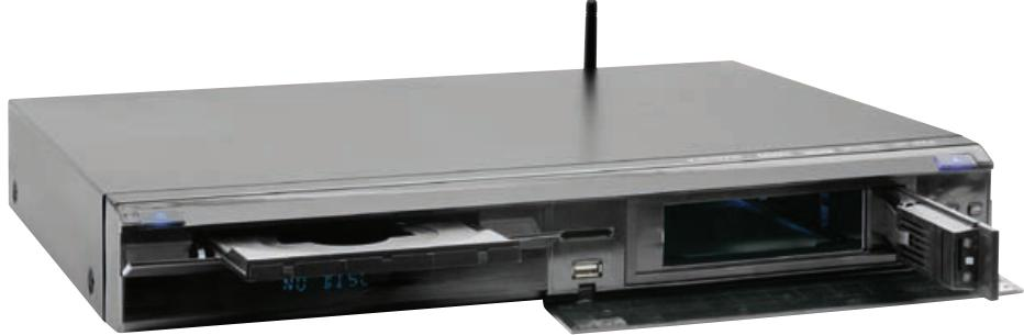
весие с оптическим дисководом. HDD держится на салазках и фиксируется крышкой отсека, пружина сверху, которая надежно фиксирует накопитель, отсутствует.
